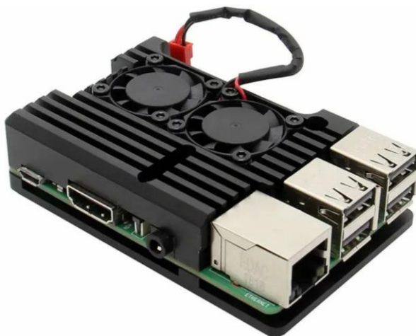
Рисунок 4 – внешний вид микрокомпьютера Raspberry pi в корпусе Аппаратное обеспечение:
